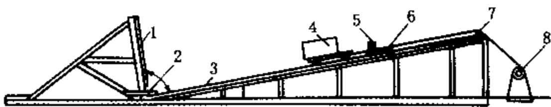
图 6-25-2 斜向冲击试验机示意图
